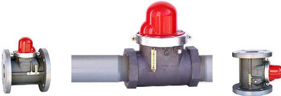
Válvulas de California son las válvulas de gas actuadas automáticamente para terremotos sensibles de cierre. Su objetivo es cerrar en el caso de un terremoto para evitar el flujo de gas en una estructura, la que puede tener el daño del terremoto ocurrido. La válvula reduce el potencial de incendio o explosión debido a la liberación de gas natural en líneas de gas, instalaciones de gas o equipos de gas.
